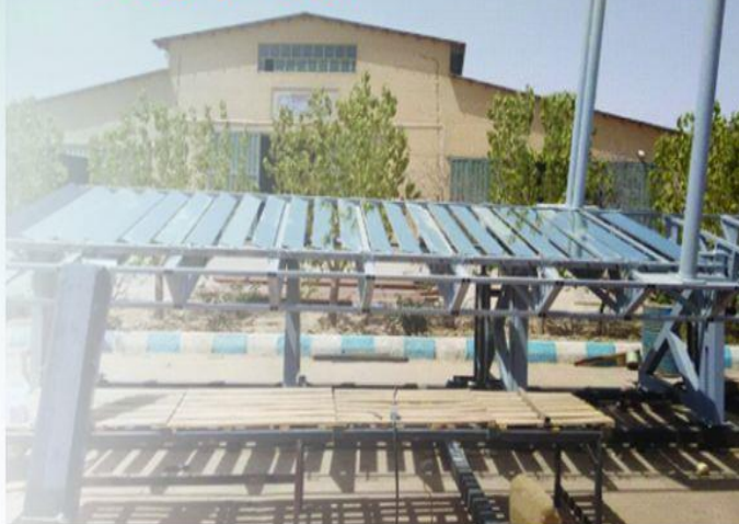
مشخصات کالکتور فرنل ساخته شده در دانشگاه اصفهان
